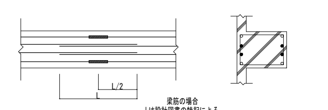
【図5.11 機械式継手・溶接継手と重ね継手併用の場合】
